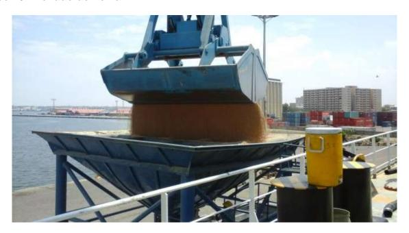
**Nota:** en caso de que el producto almacenado en las bodegas se compacte o sea necesario apilar al centro de la bodega, el Operador de Máquina ingresara con el Mini cargador Bobcat para facilitar la toma de producto con el chamshell por parte del Operador de Grúa.
